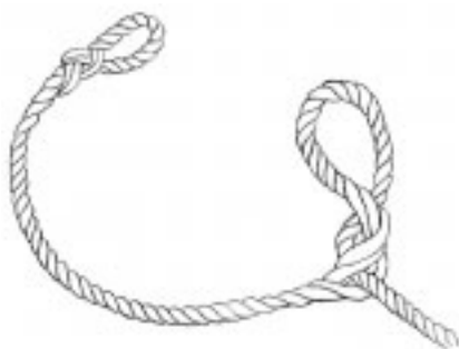
Abb. 6: In diese Öffnung zieht man nun das längere Seilende (ohne Schlaufe) in entgegengesetzter Richtung zu vorher ein und sorgfältig ganz durch, wie auf der Abbildung sichtbar. Das Seil darf dabei nicht verdreht werden.
